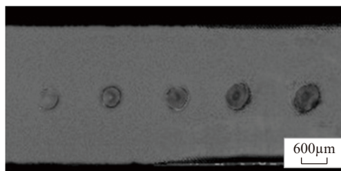
图8 焊点结合面超声检测图
